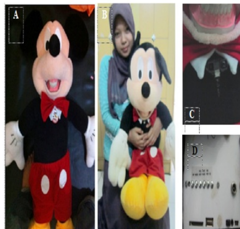
Gambar 1. (A) “Robo-Smile” tampak dari depan, (B) ukuran “Robo-Smile”, (C) Sensor untuk memudahkan membuka dan menutup gigi secara otomatis, (D) Audio controller
