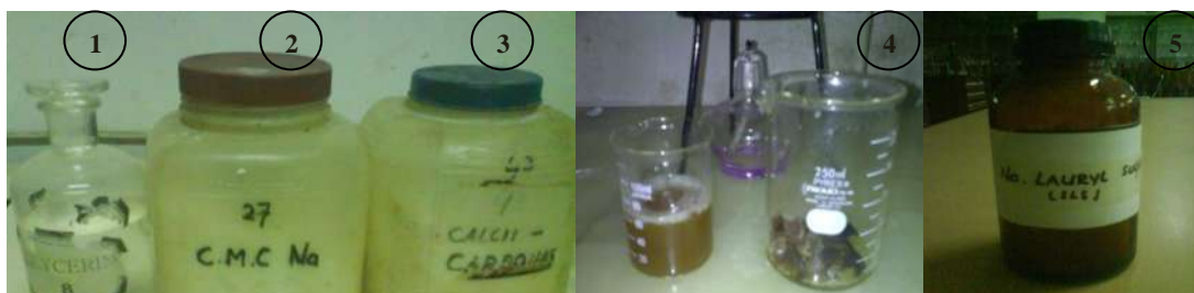
Gambar 4.2 Bahan pembuatan pasta gigi: 1. gliserin, 2. CMC-Na, 3. Kalsium karbonat, 4. Air rebusan lerak, 5. SLS
