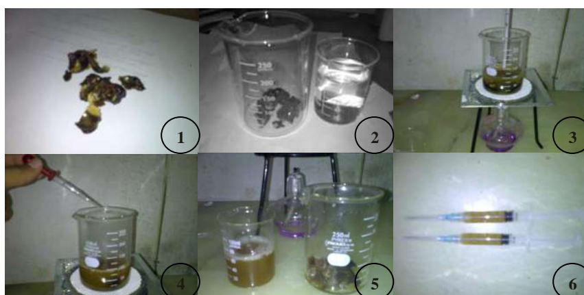
Gambar 4.4 Persiapan air rebusan buah lerak : 1. Buah lerak dipotong kecil, 2. Lerak dicampur dengan akuades, 3. Campuran buah lerak dan akuades direbus hingga mendidih, 4. Volume dipertahankan 100 ml, 5. Sediaan lerak disaring, 6. Diambil dengan syringe 2 x 2,5
