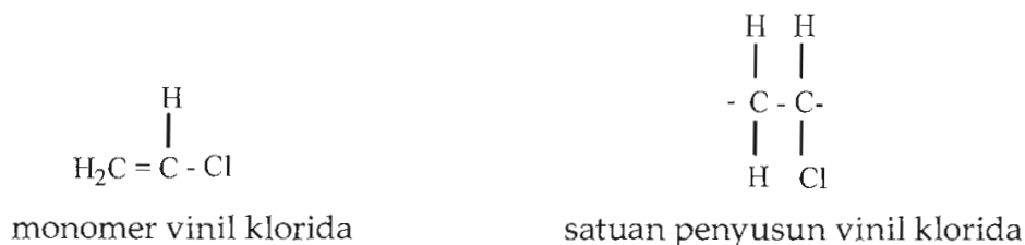
Gambar 1.1 Struktur monomer dan satuan penyusun vinil klorida.
