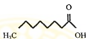
Gambar 2.3 Struktur Asam Kaprilat ( C_7H_{17}COOH )
