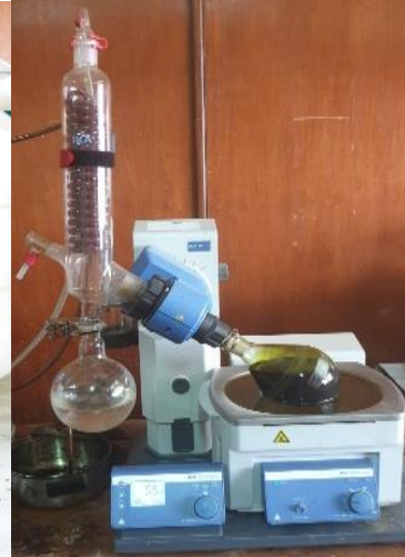
Proses evaporasi menggunakan rotary vacuum evaporator
