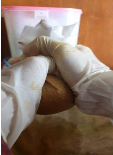
Penyaringan campuran serbuk jahe dan etanol 96% menggunakan kertas saring
