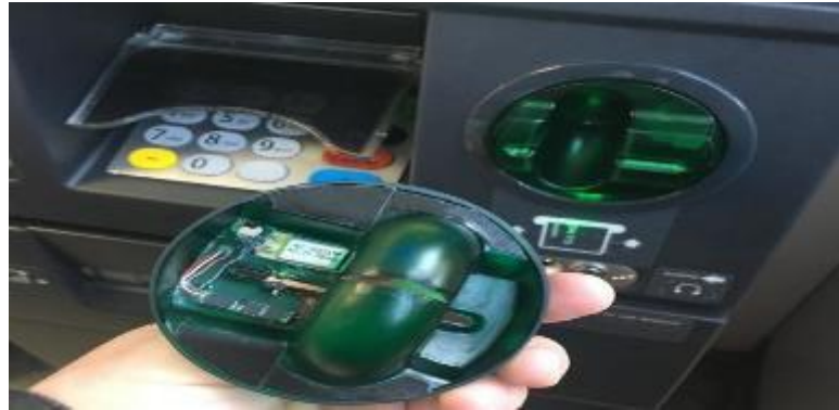
Gambar 1.3 Alat Skimmer yang di Gunakan Peretasan Kartu ATM
