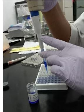
Memasukkan streptavidin-HRP ke well sampel
