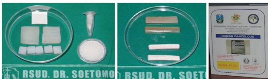
**Gambar 4.10** Berbagai bentuk *demineralized bone matrix (DBM) allograft*.<sup>30</sup>
