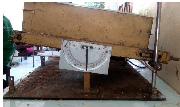
Gambar 1. Modified Columbus Standard Treadmill dengan sudut deklinasi 10°
