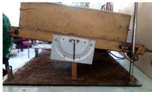
Gambar 1. Modified Columbus Standard Treadmill dengan sudut deklinasi 10°
