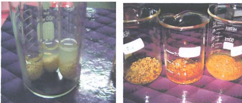
Gambar 5.3. Cross-linking dengan konsentrasi GA secara berurutan 0,5%; 1,0% dan 2,5% dari BHA-GEL dan BHA-GEL-GEN
