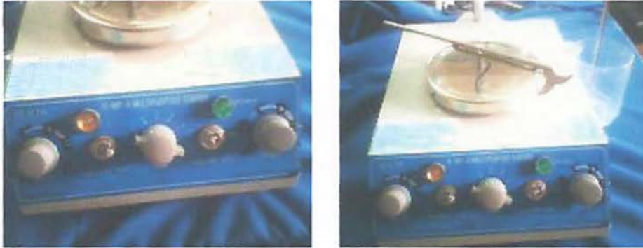
Gambar 1. Hotplate dengan 2 tombol, tombol kiri untuk magnitic stirer dan tombol kanan untuk mengatur kecepatan electric stirer (mengaduk dari atas)
