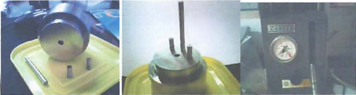
Gambar 4. Alat pencetak pelet dengan diameter 4 mm dan Carver Hydrolic untuk menekan granul atau serbuk menjadi pelet
