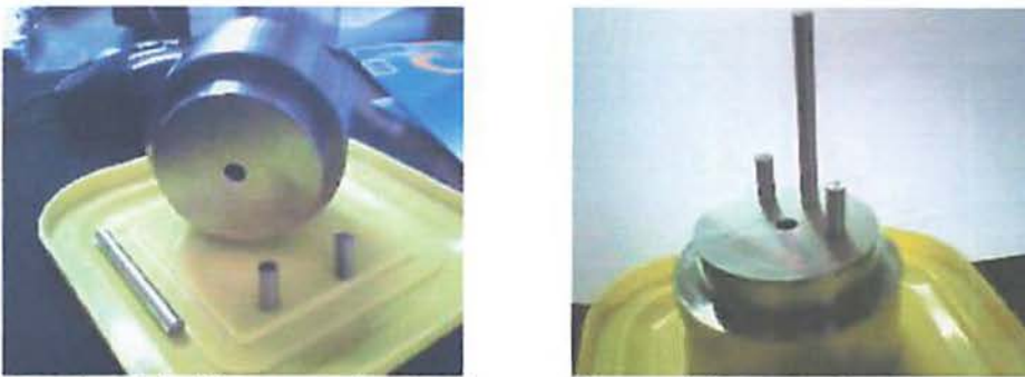
Gambar 5.5. Alat pencetak pelet dengan diameter lubangnya 4 mm
