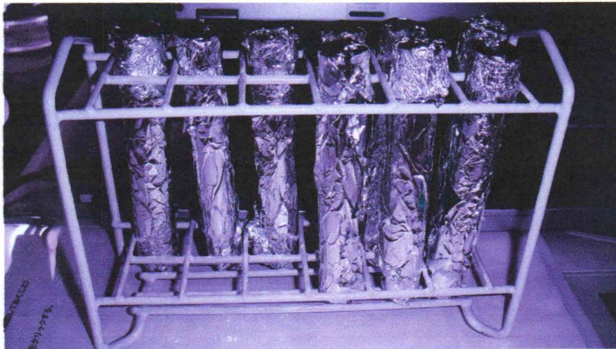
Gambar 4.1. Tabung reaksi dibungkus dengan aluminium foil, untuk menghindari adanya pengaruh sinar UV terhadap DPPH
