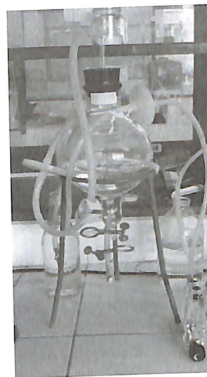
Gambar 2. Sistem kultur pada bioreaktor bergelembung tipe balon ( Balloon-Type Bubble Bioreactor )
