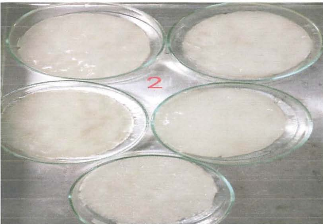
Gambar 5.3. Campuran Gelatin- Chitosan cair dicetak dengan gelas petri, masuk freezer sampai beku, terus di freeze dryer
