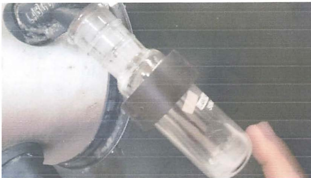
Gambar 5.4. Proses pengeringan scaffold menggunakan freeze dryer
