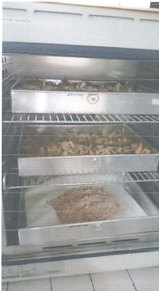
Gambar 5.1. Pembuatan Chitosan dari kulit udang, dalam lemari pemana Rak atas dan tengah kulit udang dikeringkan setelah direbus,Rak bawah Chitin, dari serbuk kulit udang setelah diproteinasi (NaOH 4%) didemineralisasi dengan HCl 0,1N, direndam dalam NaOH 2%
