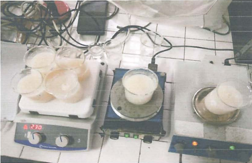
Gambar 5.2. Proses pembuatan scaffold gelatin – chitosan, diaduk dengan pengaduk magnetik pada suhu 40 – 50 0 C, selama 2 jam
