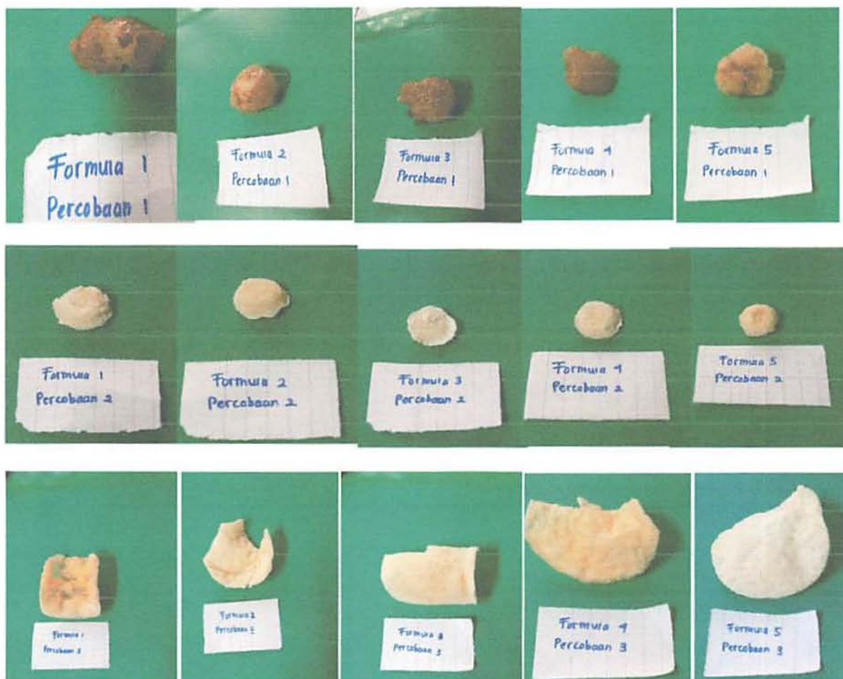
Gambar 5.6. Hasil Tiga Macam Formula dengan berbagai tahapan proses pencampuran yang berbeda, untuk mengatasi suasana asam dari asam asetat (pelarut chitosan), yang menyebabkan bahan aktif (natrium diklofenak) mengendap (menjadi Kristal)
