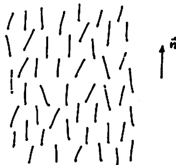
Gambar 2.4. Susunan molekul-molekul nematik. Arah orientasi molekul ditandai dengan \vec{n} .
