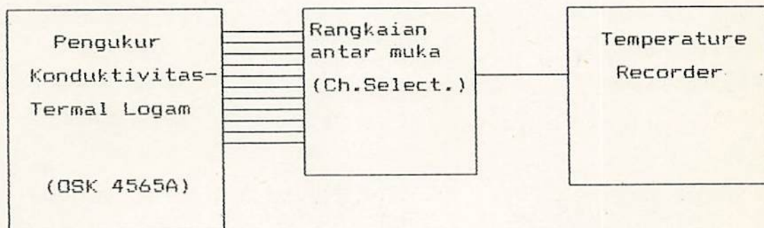
Gambar 2.3 : Susunan alat ukur konduktivitas panas logam
