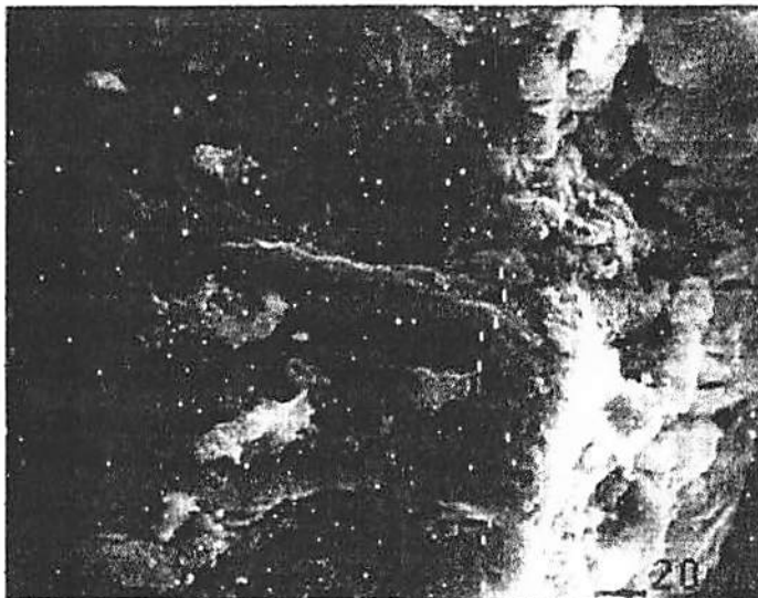
Gambar 5.9 Hasil analisis SEM ampas tahu+bentonit setelah kontak dengan ion Cu
