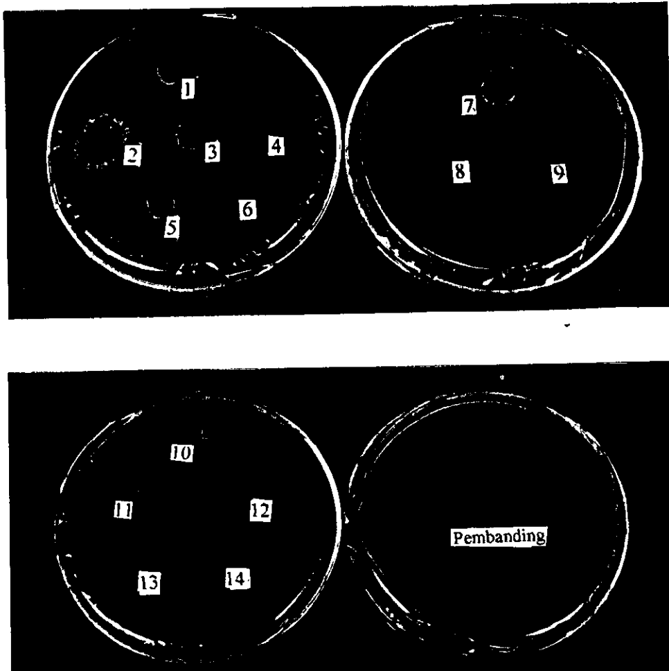
Gambar 5.1. Skrining bakteri penghasil lipase dengan metode rhodamine B agar plate
