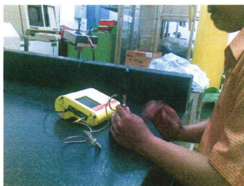
Gambar 4.6 : Alat uji kekerasan permukaan hardness vickers tester, model terbaru digital, nilai yang keluar berupa angka.
