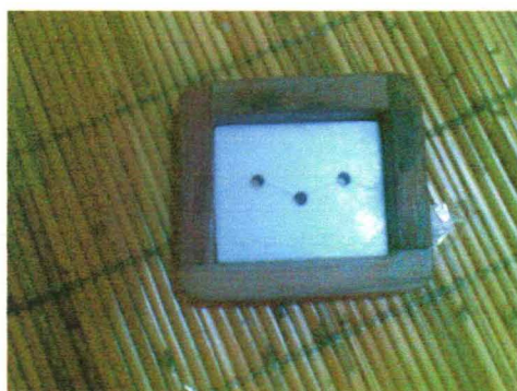
Gambar 4.3 : Gambar cetakan sampel resin komposit, terbuat dari teflon dengan ukuran tinggi 3 mm dan diameter 5 mm.
