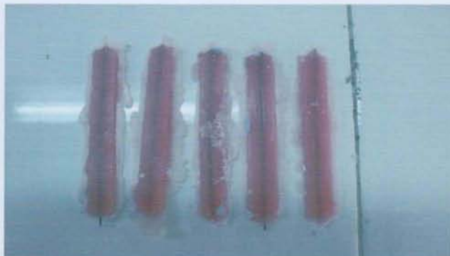
Gbr 4.2. Sampel plat resin akrilik yan diperkuat oleh kawat stainless steel (Koleksi penulis)
