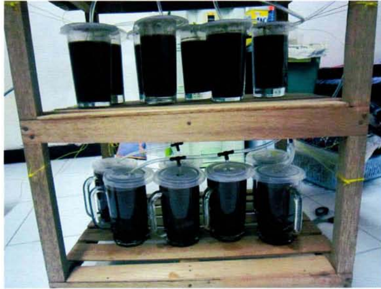
Gambar 4.7 Proses Perendaman Akrilik Untuk Konsentrasi 9gr/200ml dan 12gr/200ml
