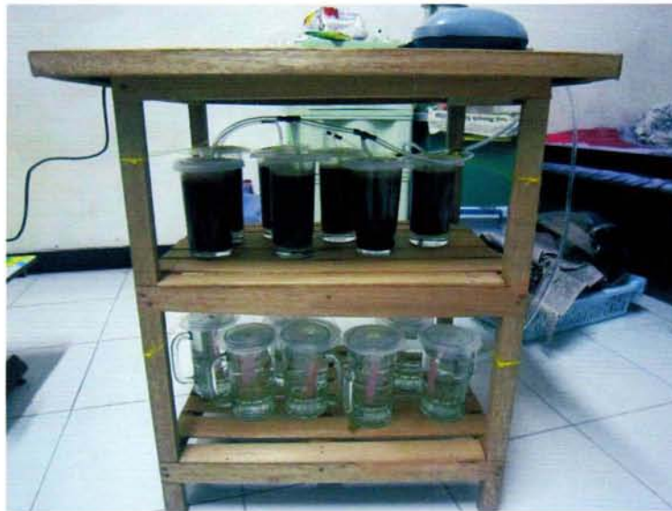
Gambar 4.6 Proses Perendaman Akrilik Untuk Konsentrasi 6gr/200ml dan Kontrol
