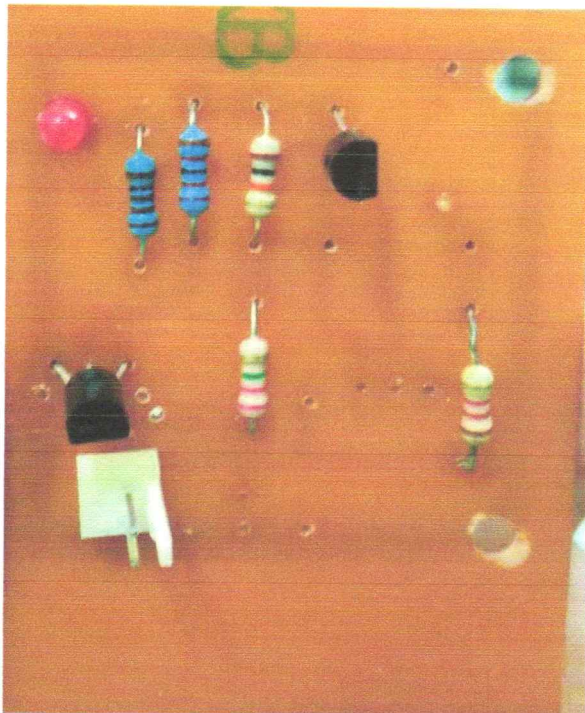
Gambar dari rangkaian penguat sensor optocoupler
