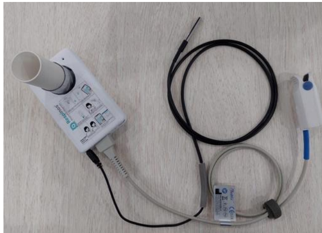
Gambar 2. Perangkat dengan sensor tempratur, SPO2, dan HR
