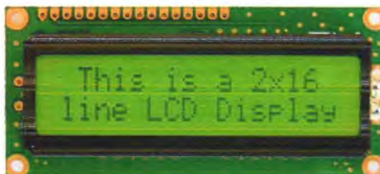
Gambar 2. 17Kenampakan LCD 16x2 (LCD datasheet)
