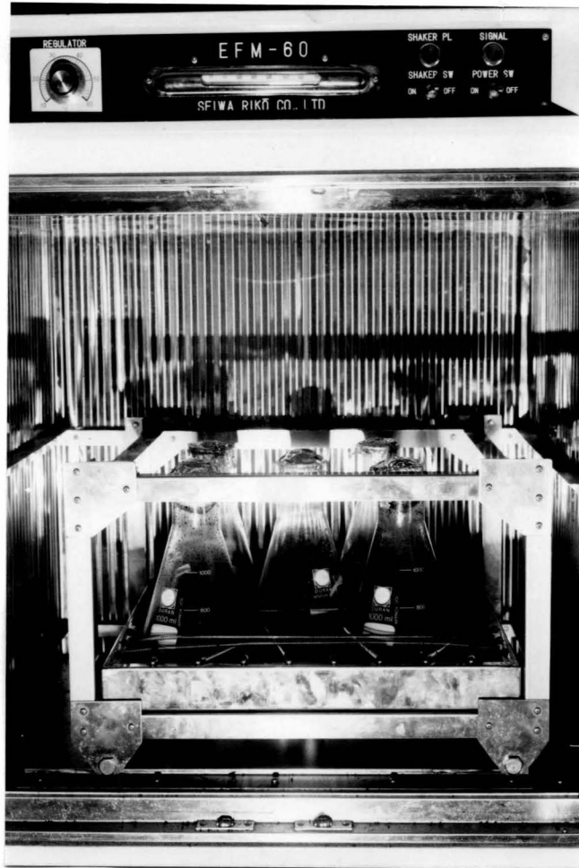
Foto 5.7 Proses biodegradasi dengan shaker incubator
