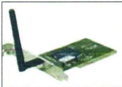
Gambar 2.5 Wi-Fi dalam bentuk PCI
