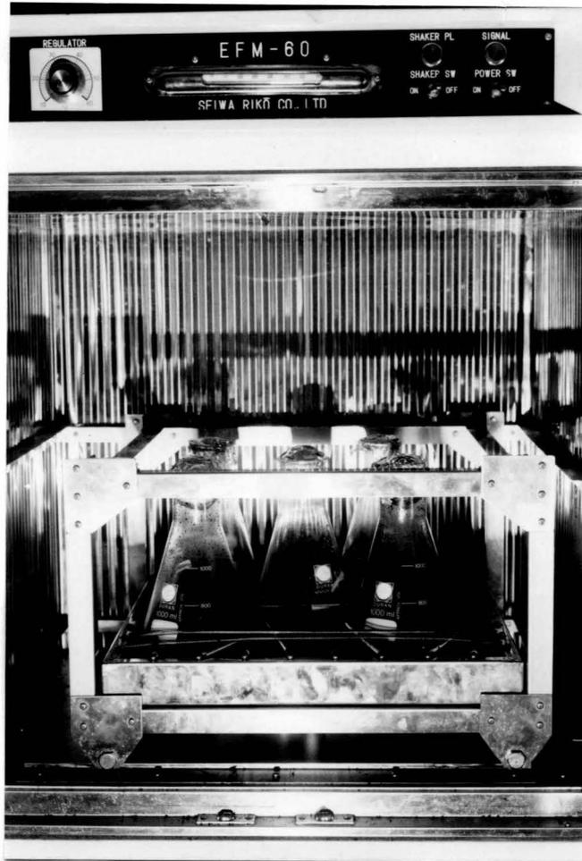
Foto 5.7 Proses biodegradasi dengan shaker incubator
