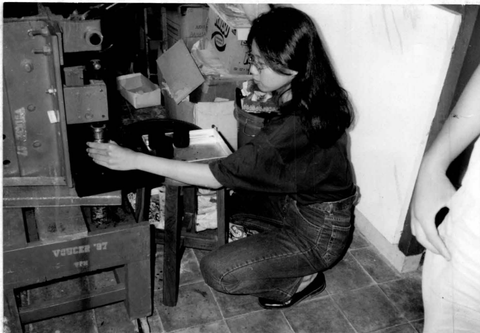
Keterangan : Kegiatan pencetakan briket
