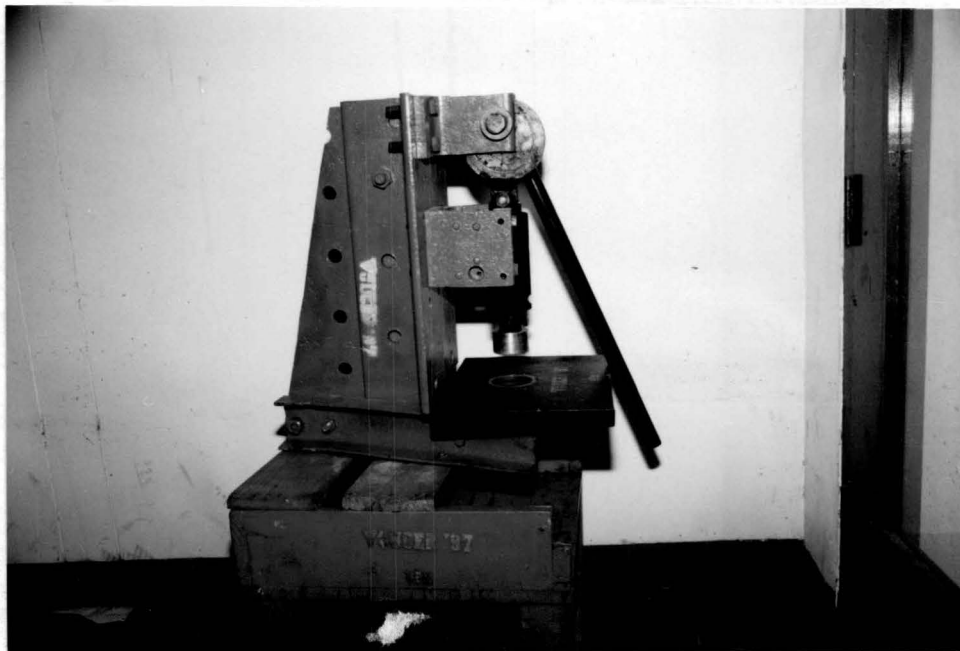
Keterangan : Alat Pencetak briket bioarang
