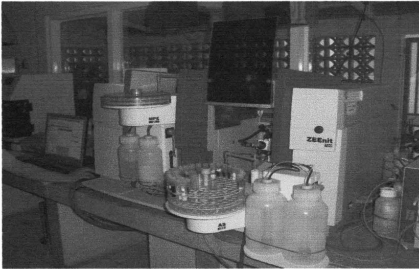
Gambar I.1 Sistem peralatan pengujian karakteristik sampel dental plaque biofilm menggunakan Spektroskopi Serapan Atom (AAS)
