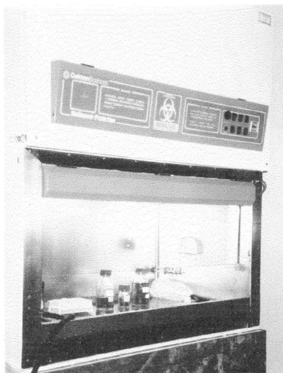
Gambar 4.8. Laminar flow : ruangan steril untuk tempat mengerjakan uji sitotoksisitas
