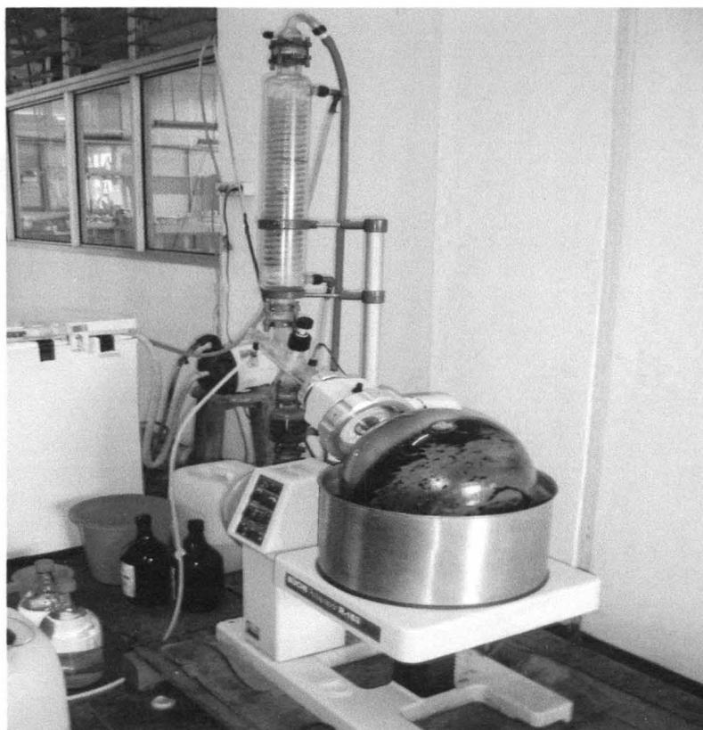
Foto 2. *Rotary evaporator* untuk memekatkan ekstrak cair hasil ekstraksi
