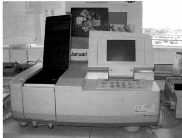
Gambar 3.7 Pengukuran kadar protein Omp Salmonella pullorum 11, Omp Salmonella pullorum AV, Omp Escherichia coli K88 dan fimbria Escherichia coli K88 dengan menggunakan spektrofotometer
