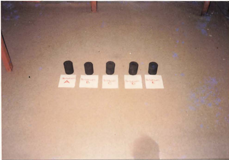
Gambar 5. Briket dengan variasi komposisi arang dari limbah isi rumen dan manure
