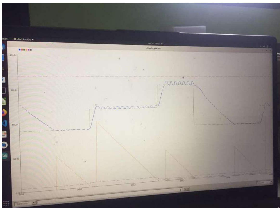
Gambar 25. Indikator grafik saat uji fungsi thermal cycler terjadi osilasi
