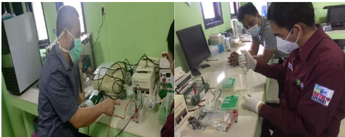
Gambar 24. Uji fungsi thermal cycler dengan pendekatan PCR konvensional dan elektroforesis
