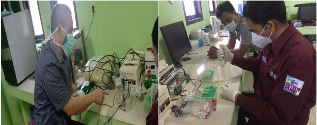
Gambar 24. Uji fungsi thermal cycler dengan pendekatan PCR konvensional dan elektroforesis
