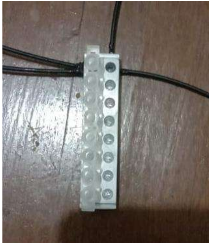
Gambar 35. Sistem penangkapan fluorescence dengan fiber optic
