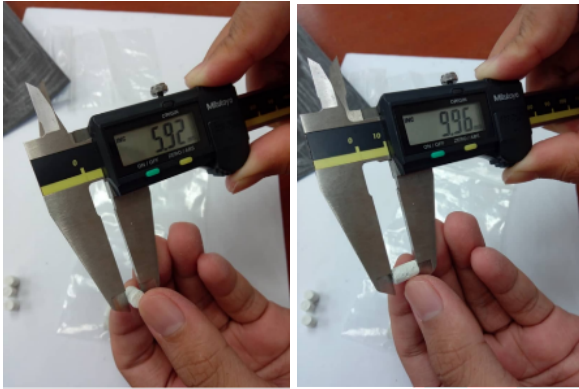
Gambar 1 Scaffold K-GEL:KA berbasis batu kapur dengan ukuran tinggi 5 \pm 0,2 mm dan diameter 5 \pm 0,2 mm
