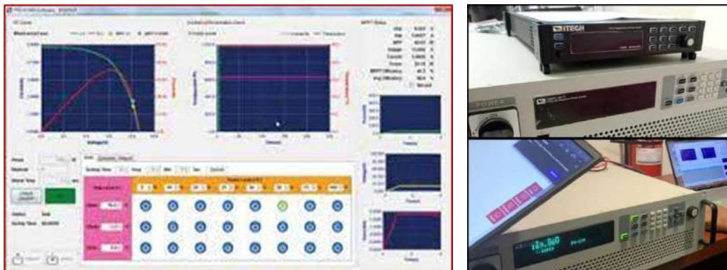
Gambar 2.2. Laboratorium Rekayasa Energi Terbarukan, Solar Array Simulator
