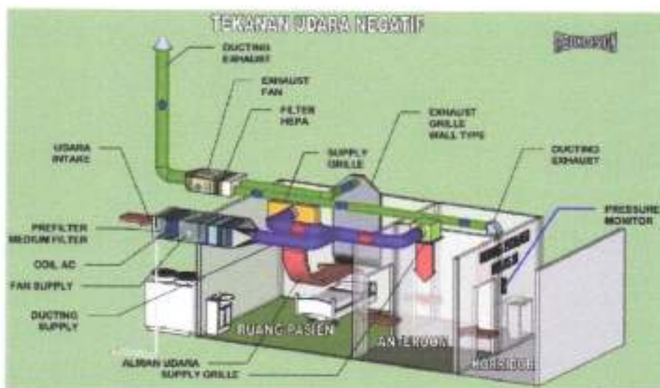
Gambar 3.2 Skematik Ruang Rawat Isolasi Tekanan Negatif
