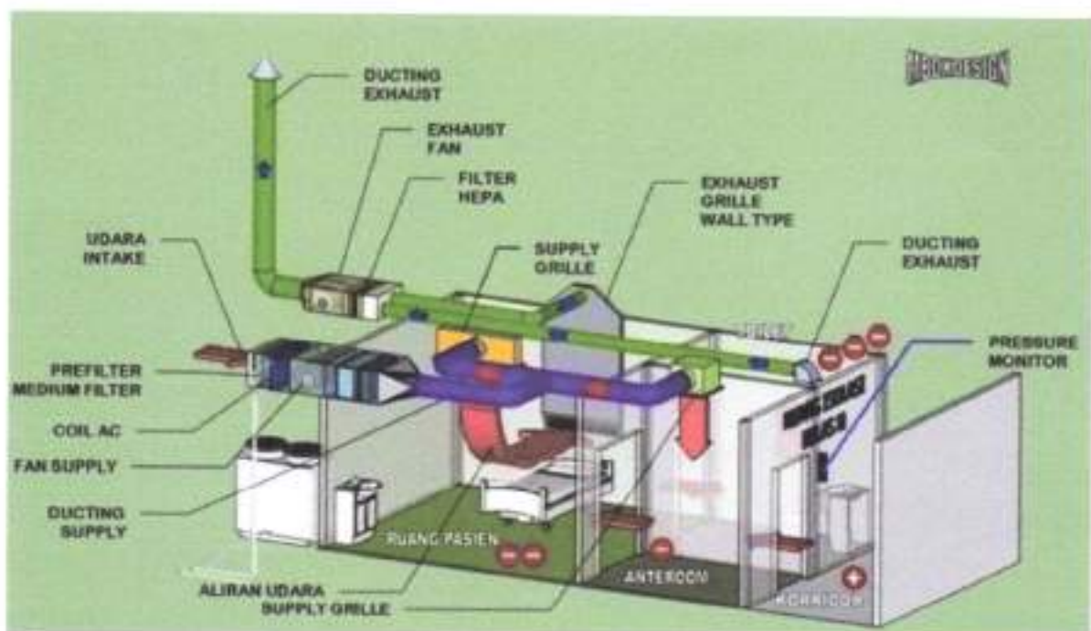
Gambar 3.7 Instalasi Tata Udara Ruang Isolasi Kelas Negatif
