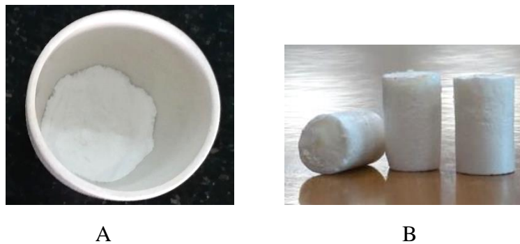
Gambar 2.8 (A) HA-TCP masih berbentuk bubuk (B) HA-TCP sudah berbentuk scaffold silinder \phi 1 mm x 2mm
