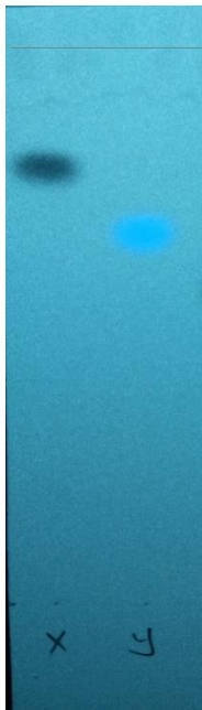
Gambar 5.3 Profil KLT isolat senyawa XND3 dan YND3, fase diam silika gel RP18 dan fase gerak asetonitril:metanol (2:1), pengamatan menggunakan UV 366
