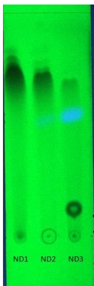
Gambar 5.2. Profil KLT hasil kromatografi kolom, fase diam silika gel F 254 dan fase gerak n-heksan:etil asetat (3:2), pengamatan menggunakan UV 254
