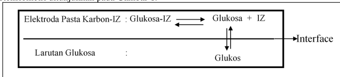
Gambar 8 Mekanisme kesetimbangan analit yang menimbulkan beda potensial
