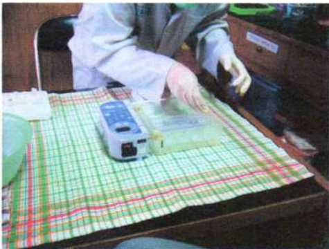
Pemindahan gel ke dalam chamber
