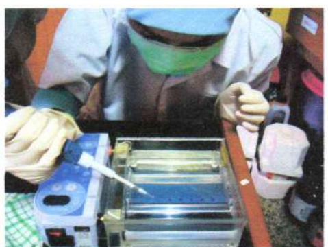
memasukkan sampel kedalam sumuran
