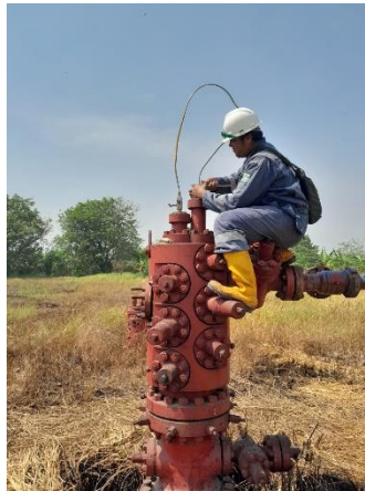
Gambar 4.2 Pekerjaan Pengecekan Tekanan Sumur
