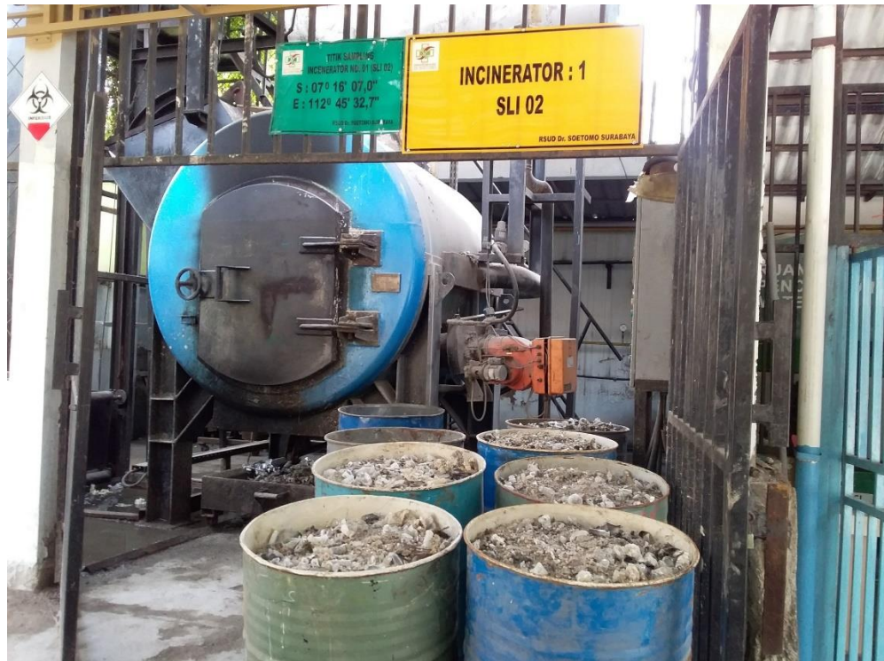
Gambar 4.7 Insenerator Dan Abu Pasca Pembakaran Limbah Medis
