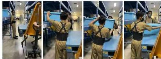
Penataan barang dengan *manual handling* menggunakan bantuan peralatan mekanis berupa *hand pallet/scissor pallet*
