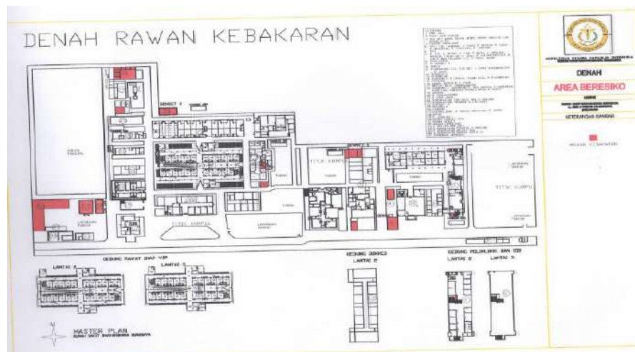
Gambar 4.4 Denah Rawan Kebakaran
