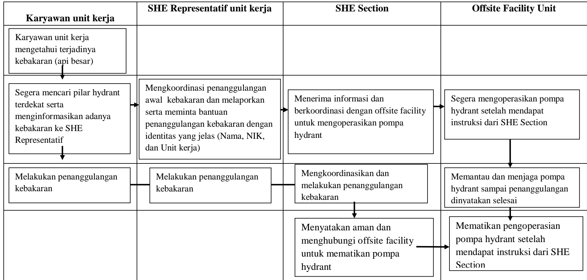
Gambar 4.13 Flowchart Pemakaian Hydrant
