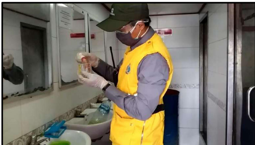
Gambar 6. Pemeriksaan Kualitas Air Bersih (Suhu, pH dan Sisa Chlor) yang digunakan di atas kapal KMP Laskar Pelangi
