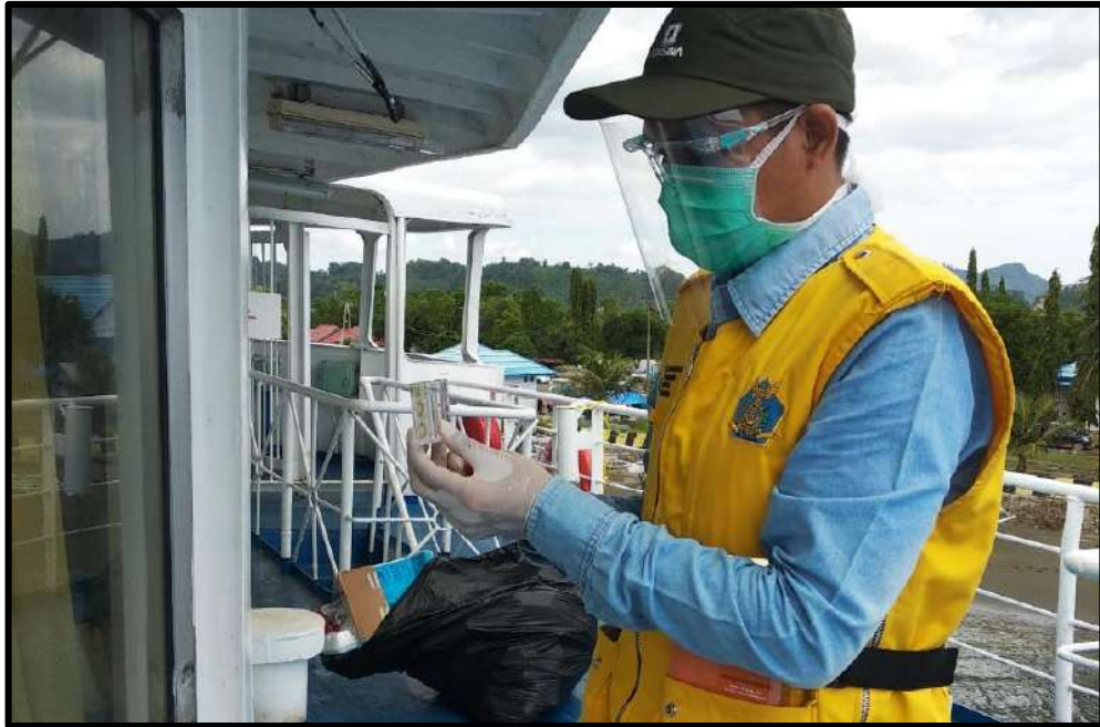
Gambar 3. Pemeriksaan Kualitas Air Bersih (pH Meter, Chlorin dan Suhu)
