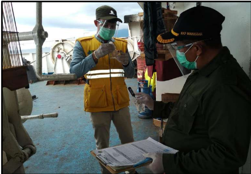
Gambar 2. Pemeriksaan kualitas air bersih (Suhu, pH, Chlor) KMP Laskar Pelangi
