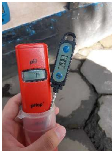
Gambar 4.2 Hasil pengukuran pH dan suhu sampel air di Kantor Unit PERUMDA TIRKAN Pakisaji
