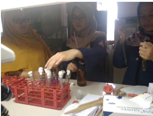
Gambar 6. 17 Uji parameter biologi E.coli pada air bersih
