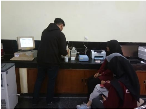
Gambar 6. 13 Analisis sampel udara menggunakan spektrofotometer
